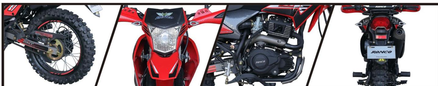
**MOTOR** Monocilíndrico, OHV, 4 tiempos, enfriado por aire, con Balanceador, Sistema ecológico.
